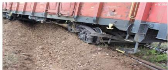
foto 4: poziția boghiului II al vagonului aflat al 17-lea în componența trenului, după deraiere
