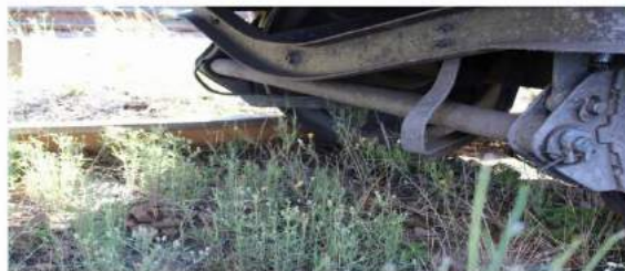
foto 3: poziția roții nr.1 a vagonului aflat al 40-lea în din compunerea trenului, după derajere
