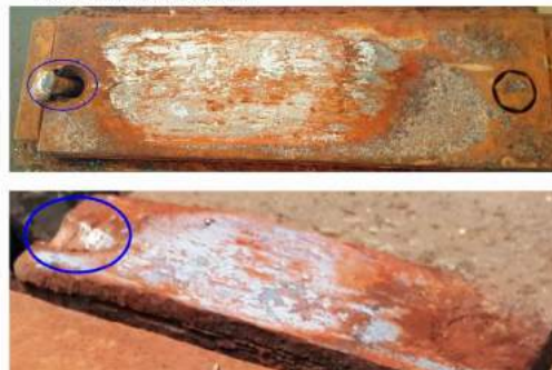
Foto nr.18 pietrele de frecare: - superioară (bulon de fixare coborât și îndoit) - inferioară având o adâncitură produsă de bulonul celeilalte
