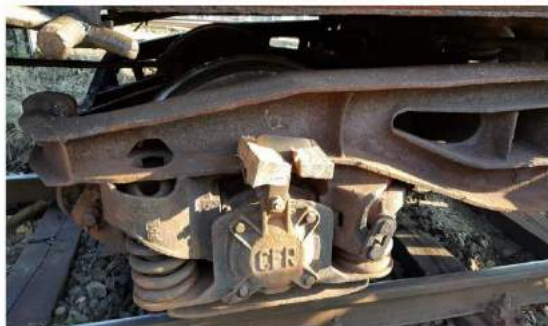
Foto nr.1 – urme de coroziune puternică a cadrului de boghiu
