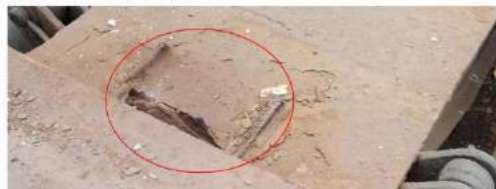
Foto nr.17 piatra de frecare inferioară lipsă, de la primul boghiu partea cu roțile 1-3
