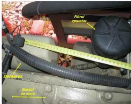
Foto nr.8 – distanța dintre cablurile demarorului și filtrul epurator la un motor nou
