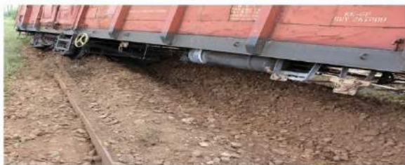
foto 3: poziția boghiului I al vagonului aflat al 17-lea în componența trenului, după deraiere
