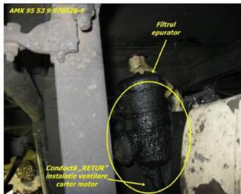
Foto nr.21 – rezidui petroliere pe filtrul epurator al automotorului AMX nr.528
