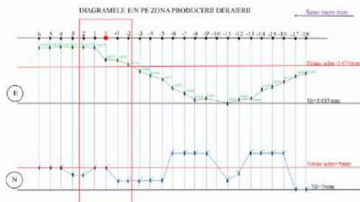
fig. 3: diagrama E/N pe zona producerii deraierei măsurată la d=0,5m
