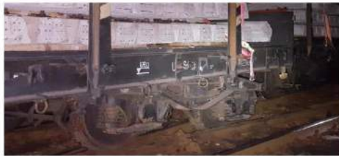
Foto nr.1 – poziția roților deraiate
