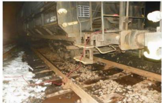
foto 2 - poziția vagoanelor nr.5 din componența trenului după deraiere
