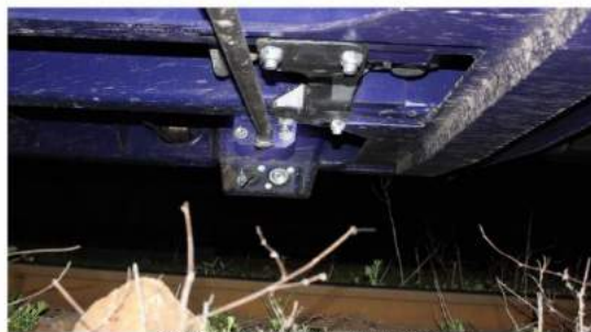
Foto 2: mecanismul de ridicare/coborâre lipsă
