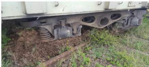
foto 2: poziția boghiului II al vagonului aflat al 16-lea în componența trenului, după deraiere
