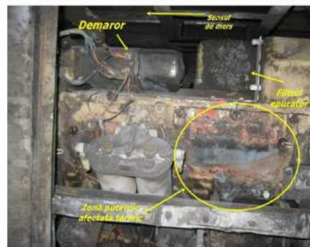
Foto nr.6 – poziționare demaror – filtrul epurator la motorul Diesel afectat
