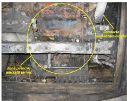
Foto nr.7 – zona afectată termic între conducta de alimentare cu ulei și pompa de injecție
