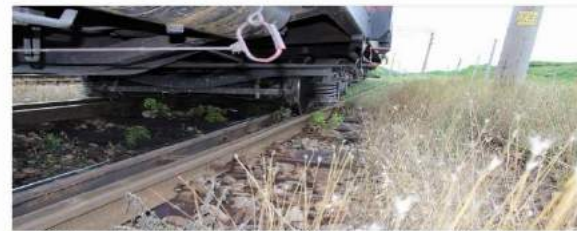
foto 5: poziția boghiului II al vagonului aflat al 24-lea în componența trenului, după deraiere
