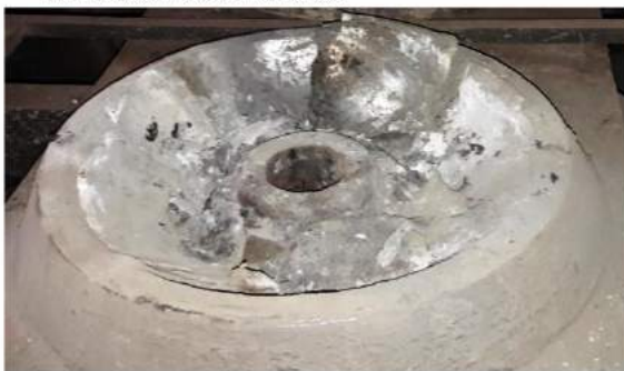
foto 25: crapodina inferioară boghiu II vagon nr. 81536652301-8
