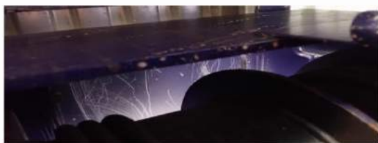
Foto 9. Lovituri și zgârieturi pe partea inferioară a șasiului
