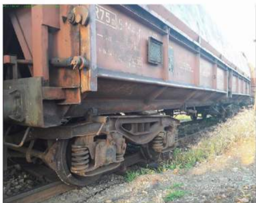
Figura 2 – boghiul deraiat al vagonului nr.31530670031-3
