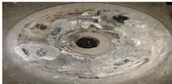
foto 23: crapodina inferioară boghiu II vagon nr.81536654073
